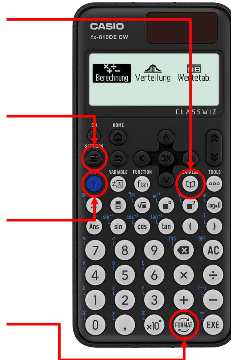
Über die Taste HOME gelangen Sie in das Hauptmenü des Rechners. Wandern Sie mit den Cursortasten über die Icons und wählen Sie mit [OK] oder [EXE] die Anwendung „Berechnung“.
